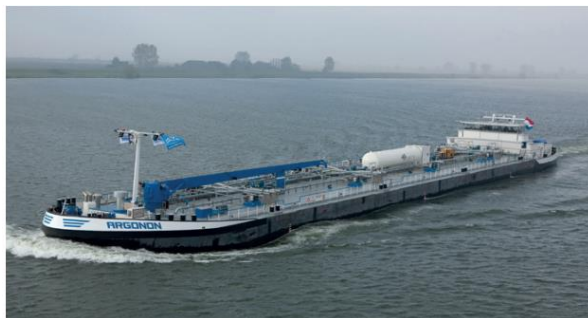
Tanker propulsé par une motorisation dual-fuel diesel-GNV (source : Deen Shipping)
