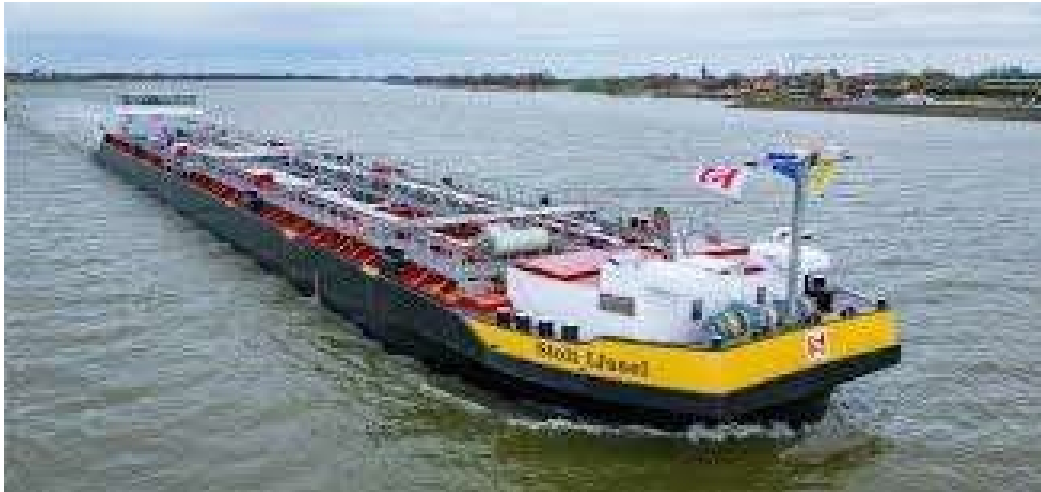
Tanker Fluvial Stolt IJssel - Propulsion méthanol-électrique
